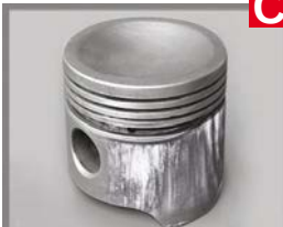
C) TALLADO DE LA FALDA A 45° / DIAGONAL SEIZURE ON THE SKIRT
