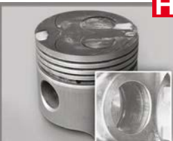
FISURAS EN: CABEZA DEL PISTÓN Y BARRENO PARA PERNO / CRACKS IN PISTON CROWN AND PIN BOSSES
