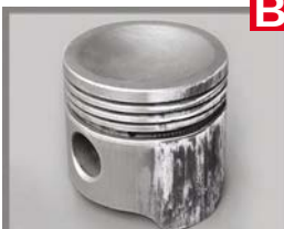
TALLADO DE LA FALDA EN EL LADO DE EMPUJE A 90° / SEIZURE MARK ON ONE SIDE
