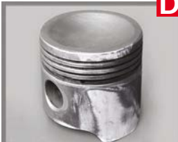
TALLADO DIAGONAL EN LA FALDA / OBLIQUE RUNNING OF THE PISTON
