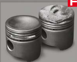
ROTURA DE LAS LANDAS, EROSIÓN EN LA CABEZA Y 1ER LANDA CABEZA PERFORADA / BREAKAGE OF THE RING LANDS AND BURNT THROUGH CAUSED BY FAULTY COMBUSTION
