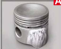
TALLADO DE LA FALDA EN AMBOS LADOS A 90° / SEIZURES ON BOTH SIDES
