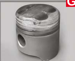
GOLPES EN LA CABEZA / DEFORMATION ON THE PISTON CROWN
