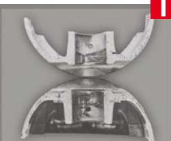
TALLADO EN EL BARRENO PARA PERNO / SEIZURE IN THE PIN BORE
